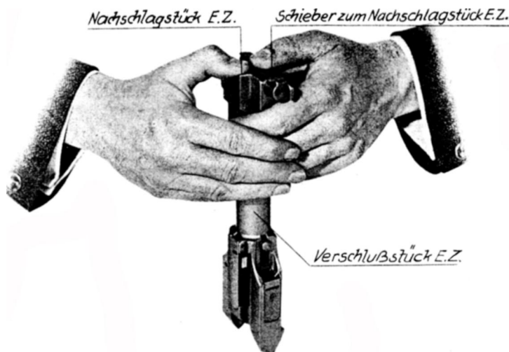
Abb. 85: Herausdrücken des Schiebers EZ zum Verschlößstück
