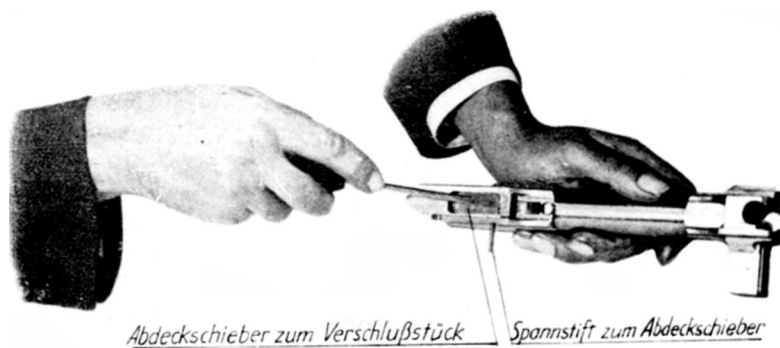
Abb. 81: Herausschieben des Abdeckschiebers zum Verschlussstück
