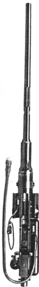
Abb. 3: MG 151/20 f. elektr. Zündung von unten gesehen
