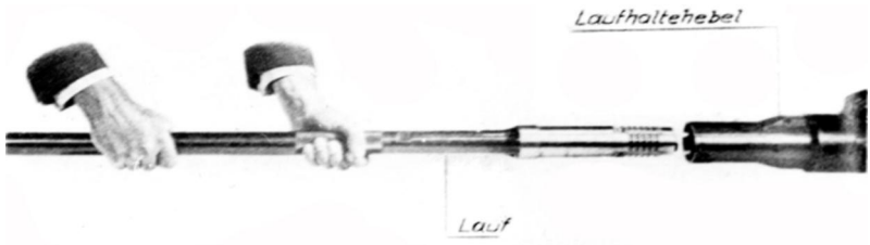
Abb. 52: Einsetzen des Laufes
