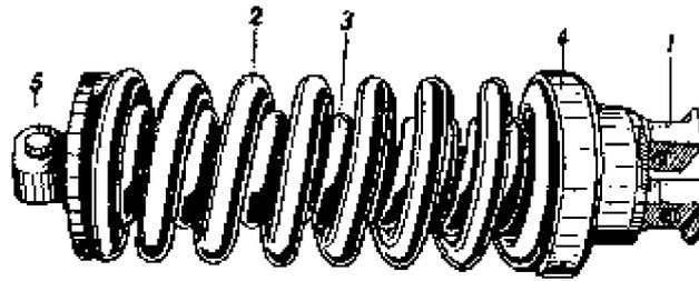
**Рис. 138.** Общий вид передней подвески в сборе;
